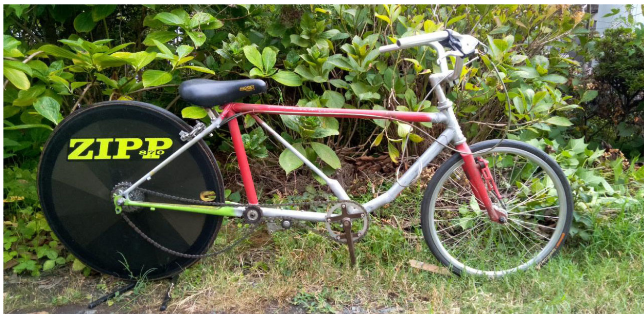
立ち漕ぎからリカンベントへ移行するポジションのテスト車両、全長 1.6m
