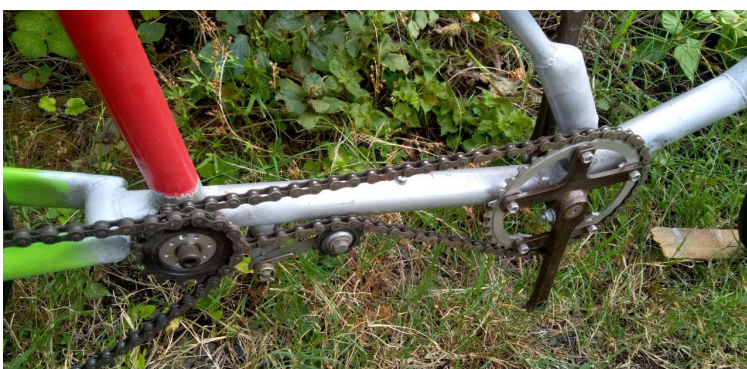
変速付きでクランクのQファクターを狭くするための2段スプロケット、この間にプロペラユニットが付く
