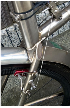
リヤはオリジナルブレーキ「ユレイ」。実体がなく、デモンタブルフレームでなければワイヤーのみで 작동する予定だった
