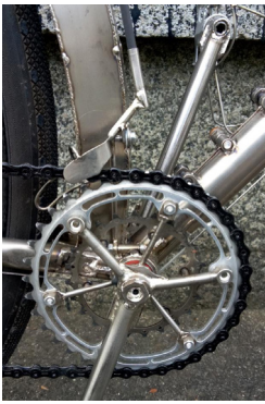
チタン製オリジナルクランク「TA フィールド」。極限の軽量化を目指してもこのデザインは絶対的
