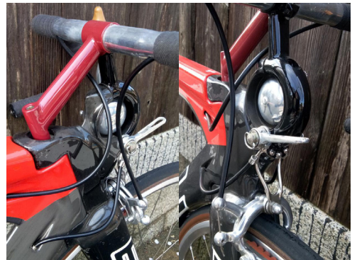
Wレバー台座 ブレーキ抜け止めが一体化になったステム
