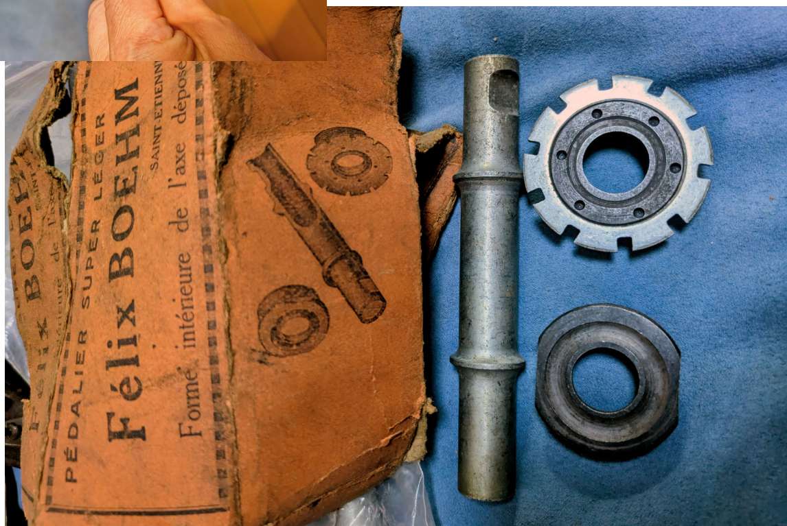
コンクールデュラルマン時代の1940年代フランス製BOEHMのコッタードBBセット。中空シャフトにコッターピン部分を凹ませて成形するという高度な技術で作られている。また、ロックリングはこの当時では珍しいアルミ製である
